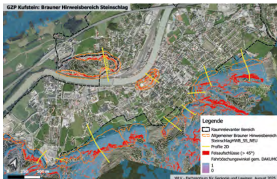
Grundlagen für die Abgrenzung von Steinschlag-Hinweisbereichen in der Stadtgemeinde Kufstein
